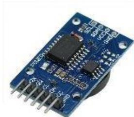
Модуль DS3231 (RTC, ZS-042) — представляет собой недорогую плату с чрезвычайно точными часами реального времени (RTC), с температурной компенсацией кварцевого генератора и кристалла. Модуль включает в себя литиевую батарею, которая поддерживает бесперебойную работу, даже при отключении источник питания.
